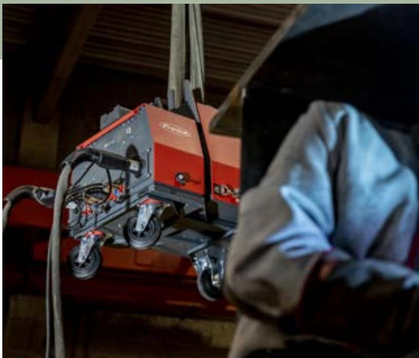
Em suas mãos: o design modular com o WF 25i Dual significa que você monta o sistema que melhor atende às suas necessidades, ajudando-o a liberar todo o seu potencial de soldagem. Dependendo da aplicação de soldagem, a montagem pode ser realizada de forma compacta no carrinho ou com um guindaste em ambientes de soldagem de difícil acesso. O Trabant também é a escolha certa para um raio de operação de até 25 m, o que facilita e torna conveniente a sua utilização.
